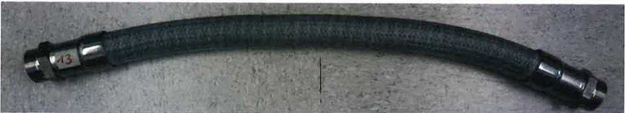
Abbildung 7: Förderschlauch vom Typ Corroflon GP/AS/KYB/EC
