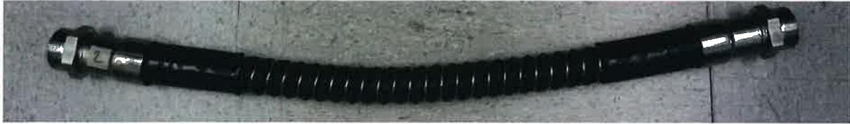
Abbildung 1: Förderschlauch vom Typ Corroflon GP/AS/TO
